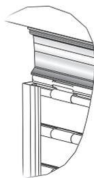
Attaches spécifiques pour suspendre le tablier aux lames standards des rideaux métalliques.
